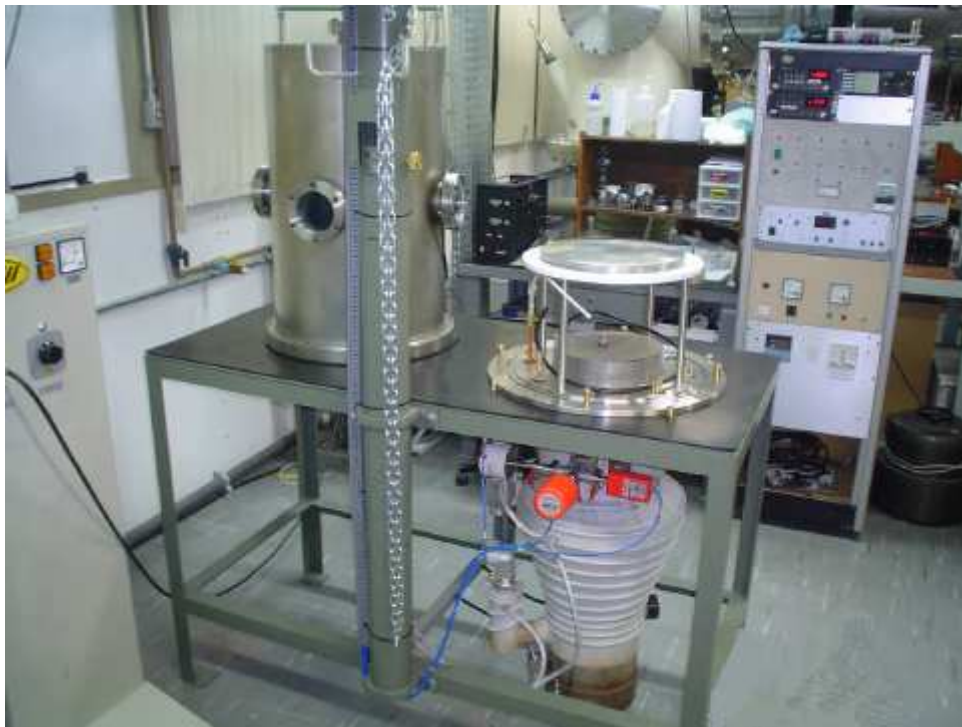
Figura 3.1 – Câmara de deposição de DLC através da técnica DC pulsado PECVD .
