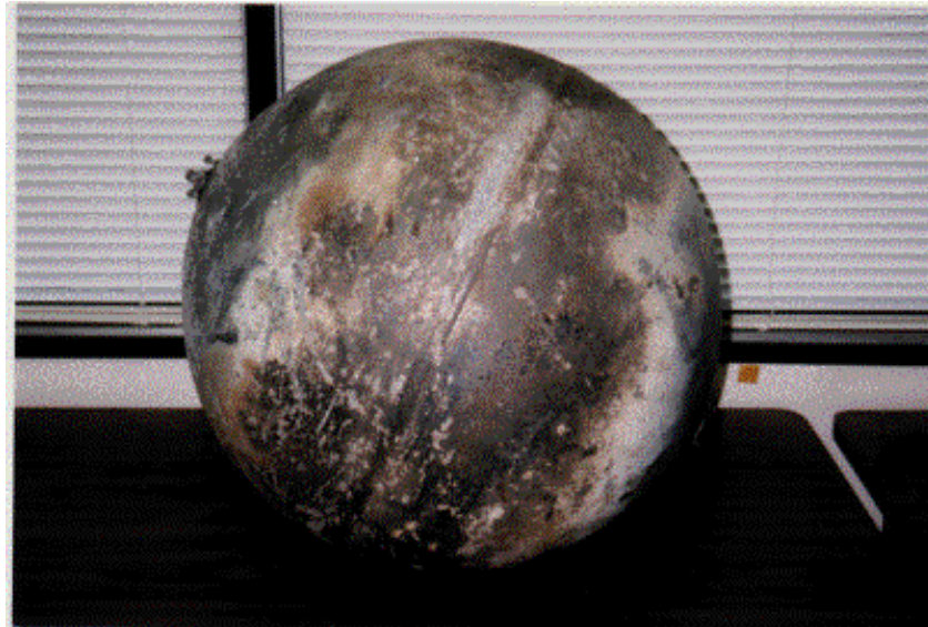
Figura 2.28 – Esfera de Pressão do Segundo Estágio do Foguete Delta 2, encontrado em Seguin, Texas.
