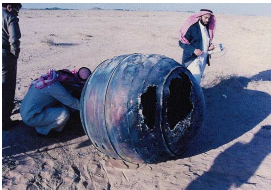
Figura 2.31 – Motor de Titânio do Terceiro Estágio do Foguete Delta 2.
