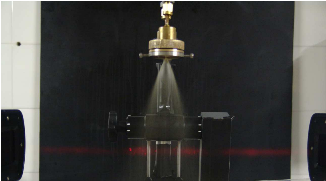
Figura 8.9 - Imagem da posição espacial do injetor com o feixe laser emitido pelo instrumento de difração laser.
