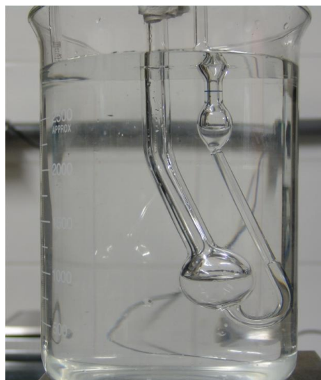
Figura A.5 - Arranjo experimental para realizar a medição de viscosidade.
