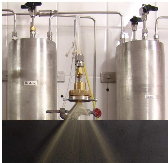
Figura 6.14 - Spray formado pela mistura de etanol e biodiesel de soja para 1 bar de pressão manométrica.
