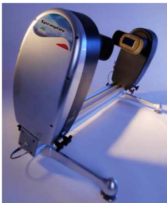
Figura 8.2 - Sistema de difração laser Spraytec da empresa Malvern.
