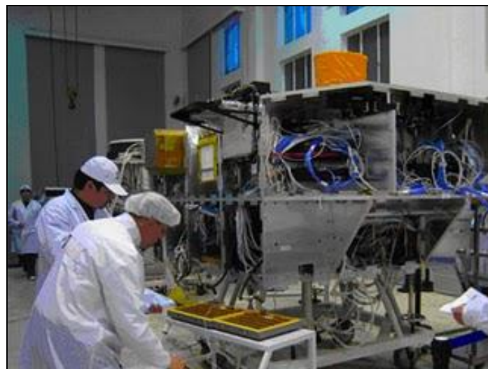
Figura 2.12 – Montagem do satélite CBERS-2B utilizando painel sanduíche-colméia.
