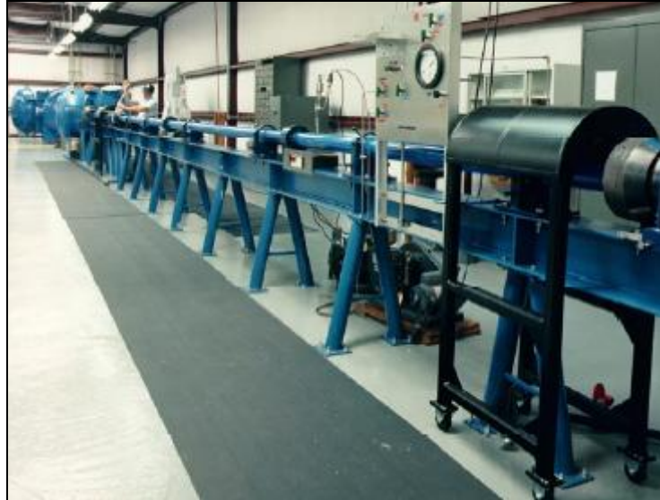
Figura 2.3 - Sistema de testes de hiper-velocidade utilizado para caracterização de blindagens.
