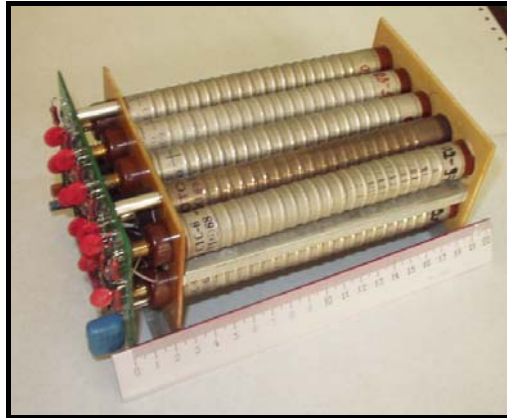
Figura 3.2 – Detalhe de um bloco com 10 contadores do CARPET.
