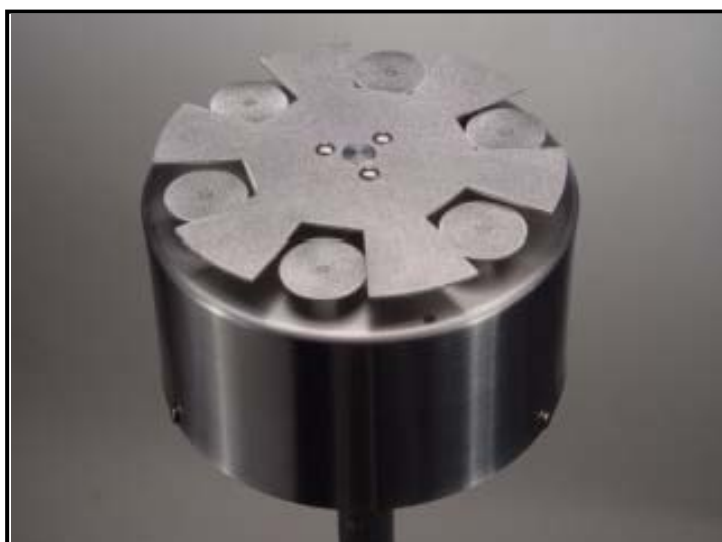
Figura 3.13 – O monitor de Campo Elétrico EFM-100.
