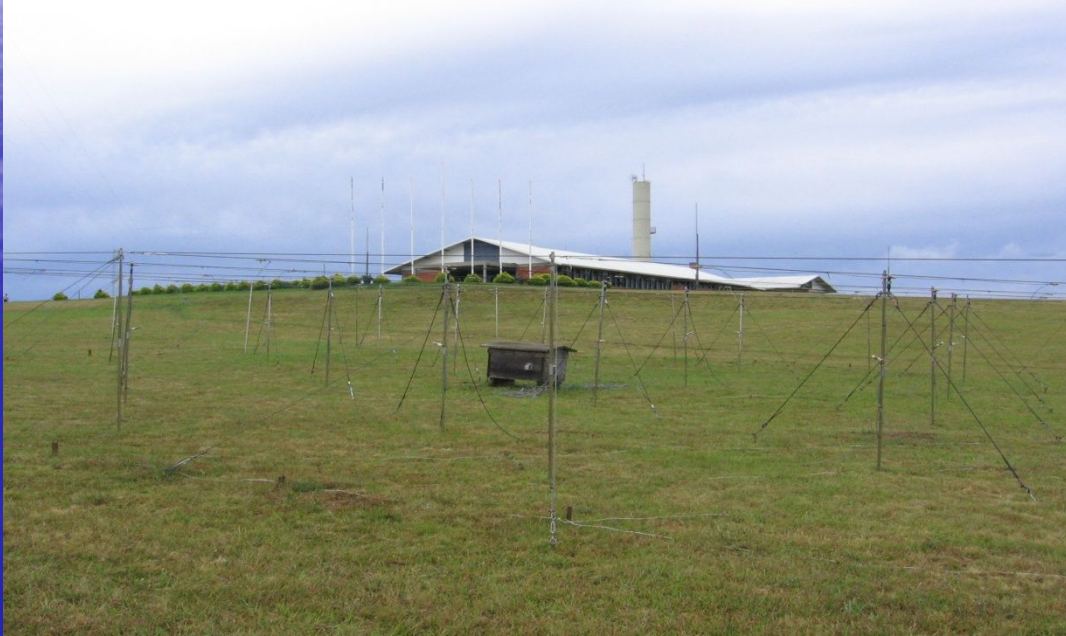
Figura 4: Sistema Riômetro Imageador instalado no Observatório Espacial do Sul.
