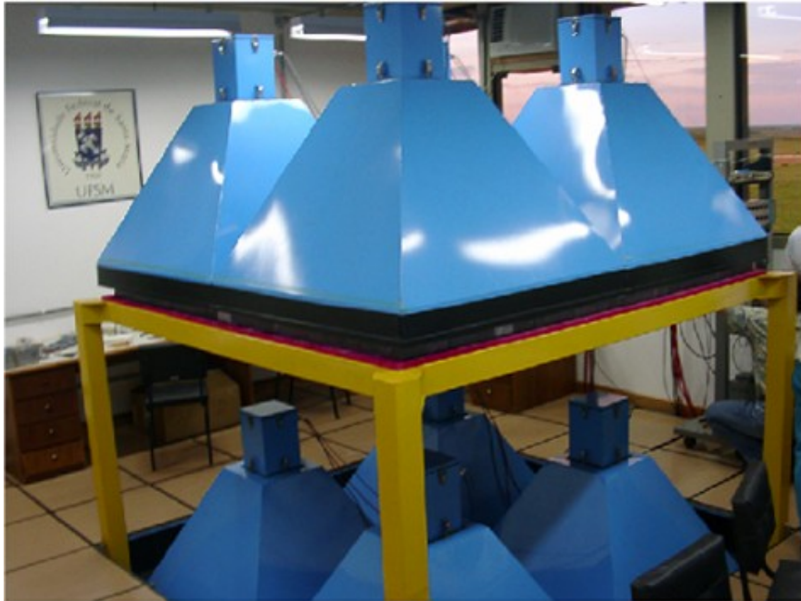
Figura 4 – Detector Multidirecional de Muons – DMM - Protótipo
