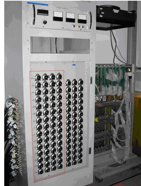
Figura 10 – Fontes de alimentação e sistema de processamento de sinais do detector de muons.
