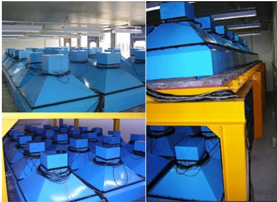
Figura 6 – Telescópio Expandido, 56 detectores.
