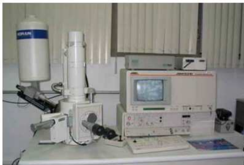
Figura 3.3 – Imagem do MEV usado no presente trabalho.
