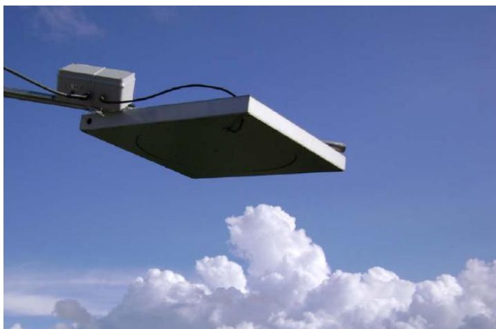
Figura 3.8 - Foto da antena instalada no topo da torre de observações de tempestades do ELAT no CTA.
