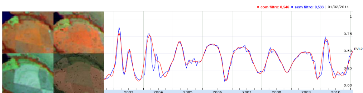
Figura 4.3 – Imagens Landsat (março, junho e agosto) e QuickBird e Curva da série temporal de EVI2 do MODIS adquirida para o Ponto 1.
