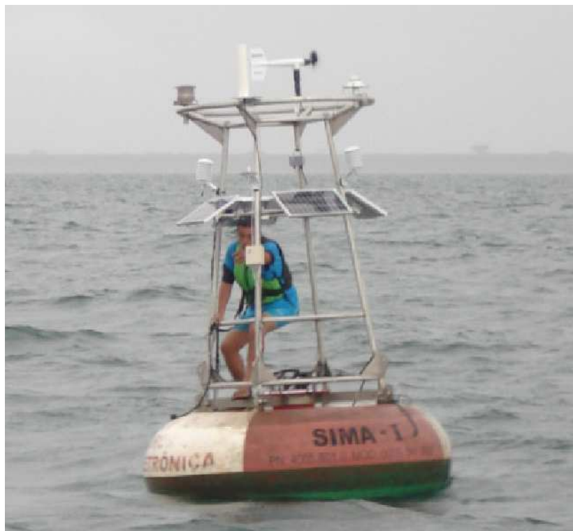
Figura 3.6 - Foto da boia SIMA instalada no reservatório de Itumbiara. Fonte: Alcântara et al. (2010)
