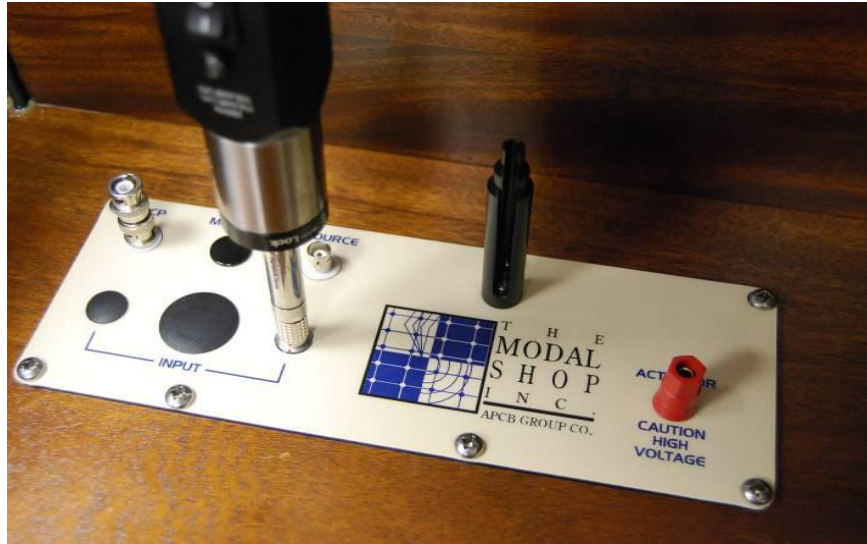
Figura 3-2: Pistonfone acoplado a um microfone durante calibração
