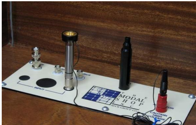
Figura 3-3: Atuador eletrostático acoplado ao microfone durante calibração
