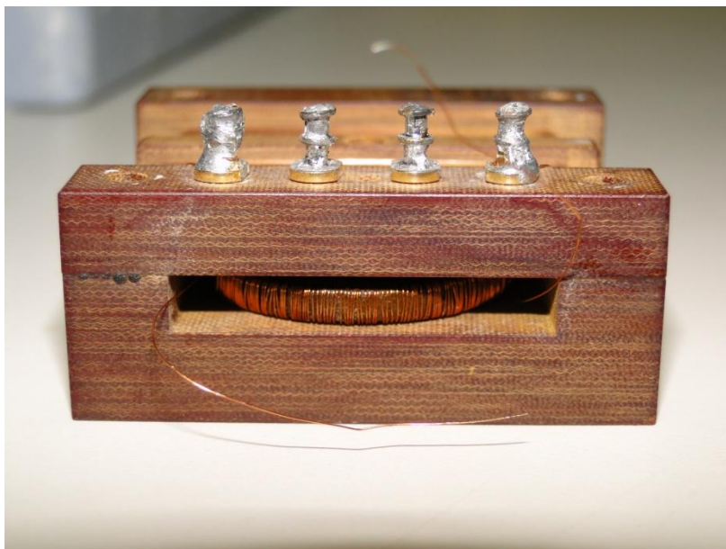
Figura 4.7: Sensor composto pelas duas bobinas e o núcleo de alta permeabilidade magnética desenvolvidos no Laboratório de Eletrônica do CRS/INPE-MCT
