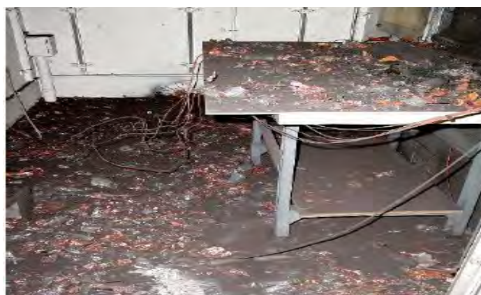
Figura 1.5 – Efeito de avalanche térmica devido à sobrecarga em um protótipo de bateria.
