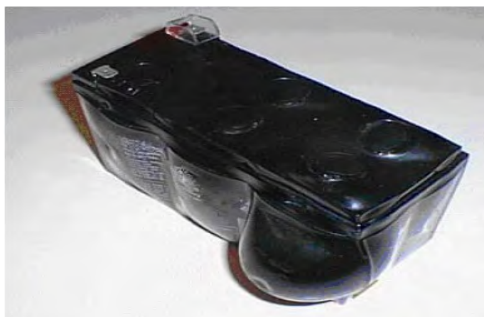
Figura 1.4 – “Inchaço” em bateria, mostrando efeito de avalanche térmica.
