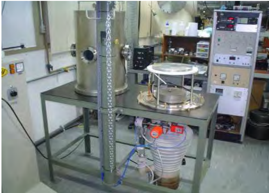
Figura 3.3 – Câmara de deposição de DLC. Fonte: Silva (2011).
