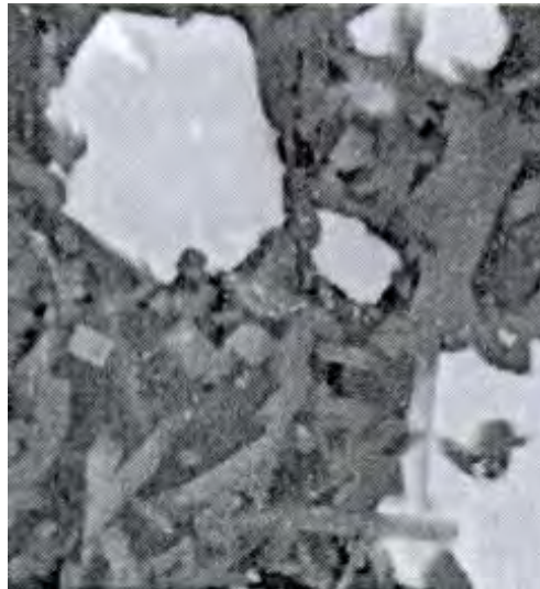
Figura 2.9 – Micrografia de BSE de basalto com uma camada condutora de ouro representando contraste dos materiais: cinza claro ( \text{Fe}_3\text{O}_4 , magnetita), cinza médio ( \text{MgFeSi}_2\text{O}_6 , piroxeno) e cinza escuro (vidro álcali-terro-álcali-aluminossilicato, em torno de 80% Si, 10% Al) Fonte: Adaptado de Reimer (1998)
