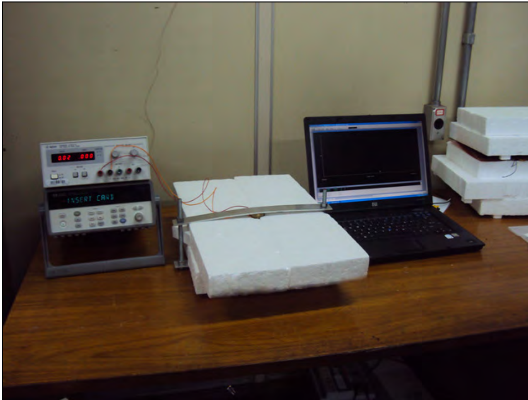
Figura 5.13 – Configuração do teste transiente em ambiente convectivo.
