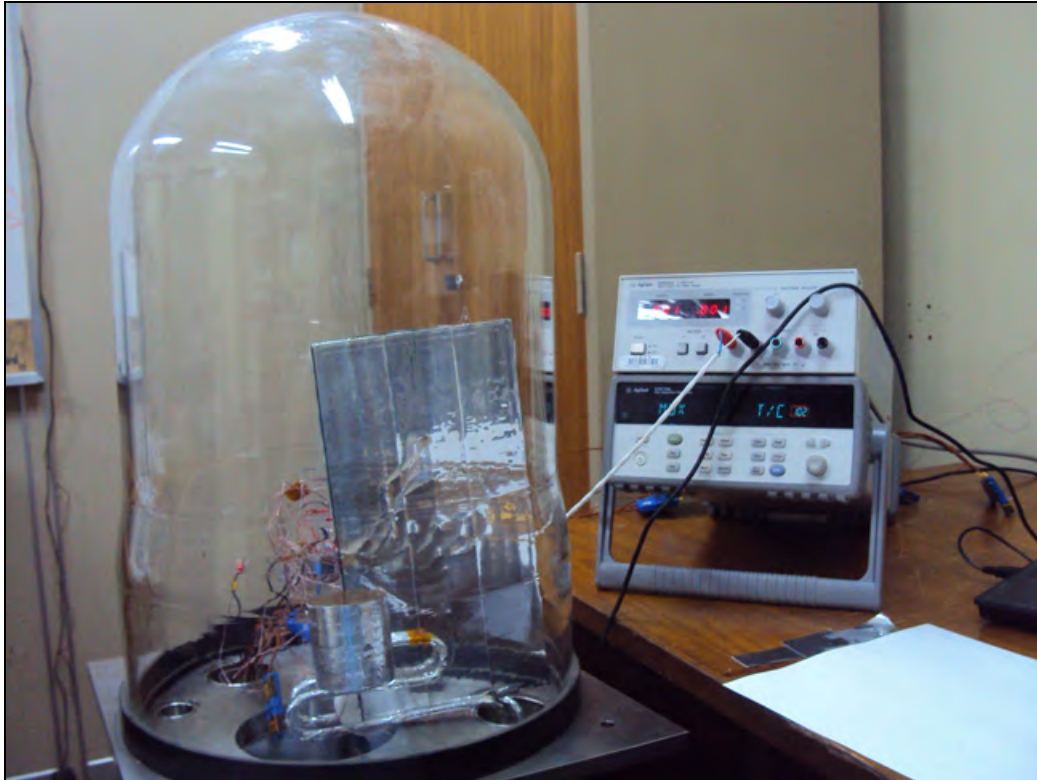
Figura 5.16 – Configuração do teste transiente em vácuo.
