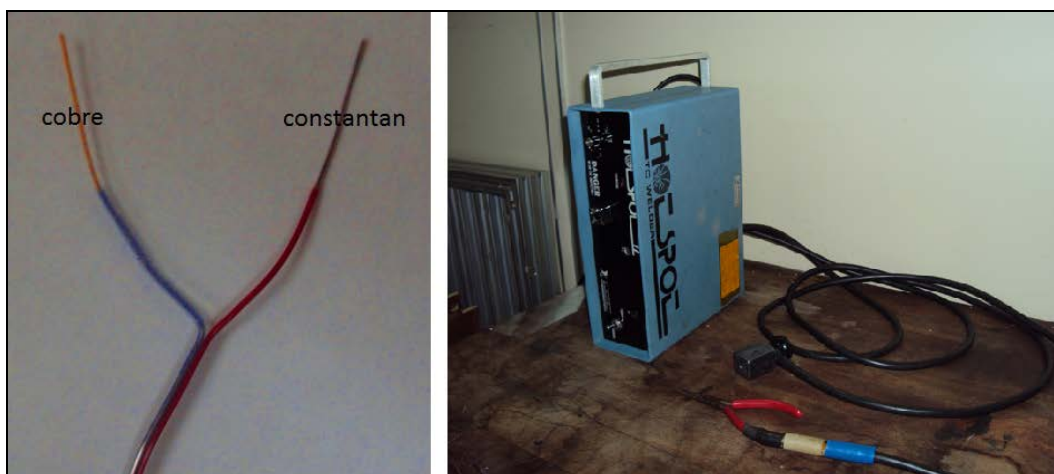
Figura 5.1 – Fios de cobre e constantan para confecção de termopares do tipo T e equipamento de solda.
