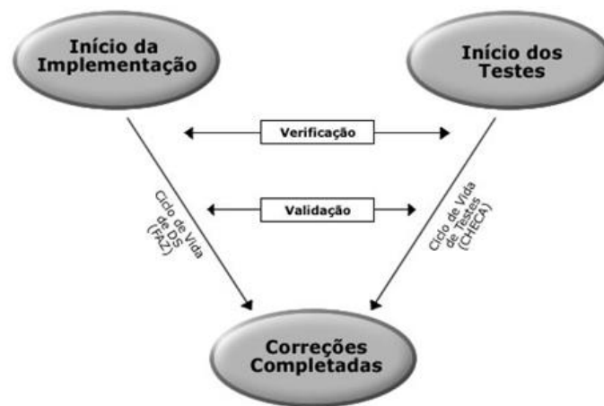
Figura 3.1 - Conceito “V” de teste de software. Fonte: Bastos et al. (2007)
