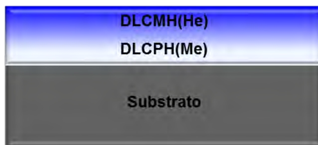
Figura 3.2 - Diagrama esquemático mostrando o filme de DLC obtido com gradiente de concentração de hidrogênio.
