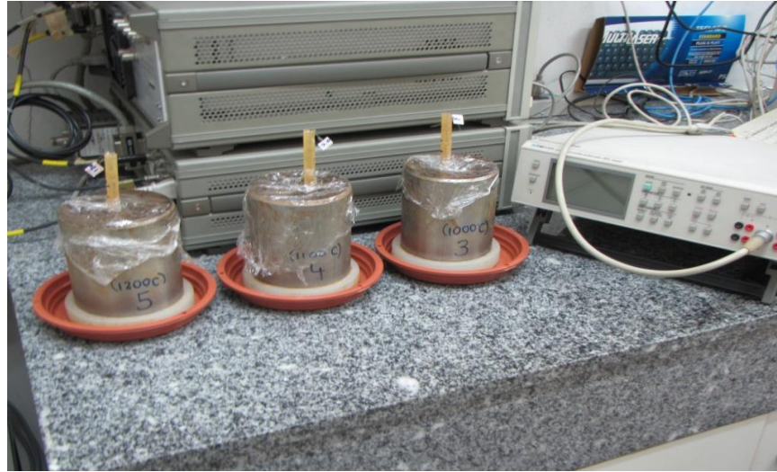
Figura 3.4 – Foto das amostras de solo com estrutura indeformada, os elementos sensores e a ponte RLC.
