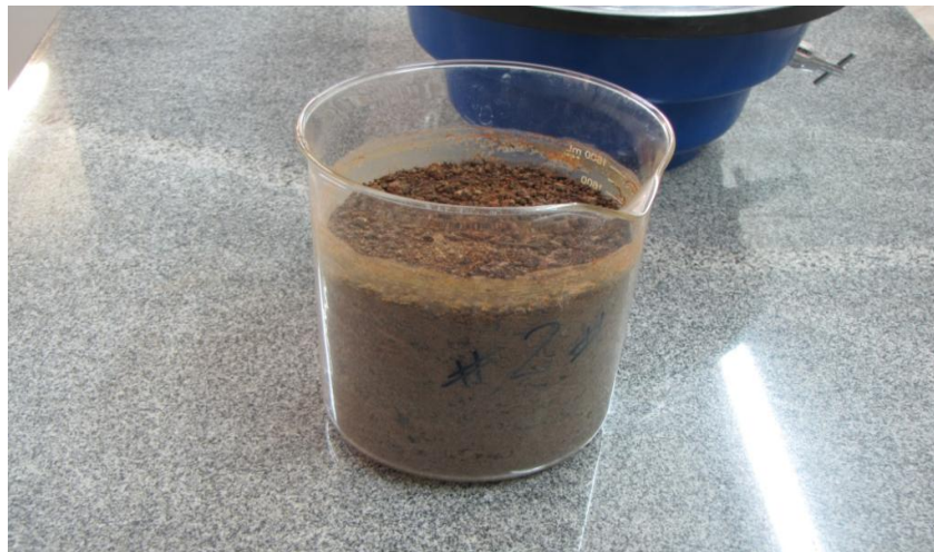
Figura 3.5 – Foto da amostra de solo com estrutura deformada.
