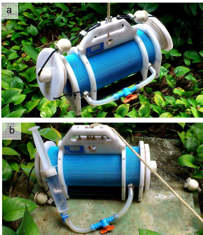
Figura 1. (a) Garrafa de Van Dorn, para coletas em diversas profundidades. (b) coleta de água da garrafa de Van Dorn.
