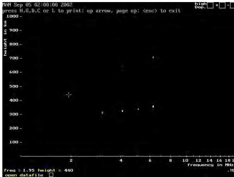
Figura 1.3 - Exemplo de um ionograma com 6 frequências, arquivo tipo MD3, gerado pelo programa do Fabricante da CADI.(Imagem não editável).
