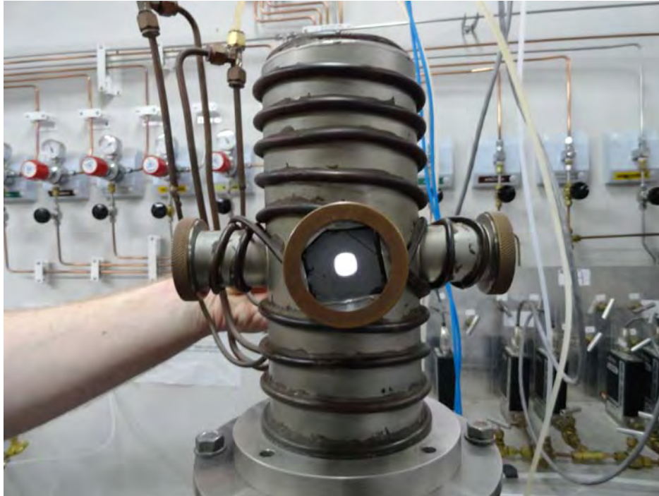
Figura 4.25 – Reator adaptado com janela NCD para teste de pressão
