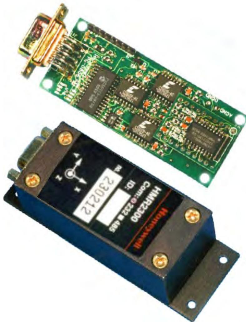
Figura 2.11 - Magnetômetro HMR2300
