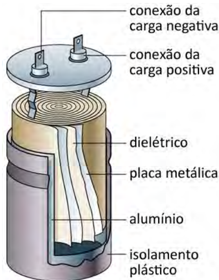
Figura 3.3 – Desenho esquemático de um capacitor eletrostático.
