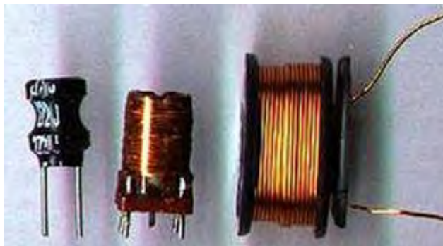
Figura 3.16 - Indutores feitos de fios de cobre enrolados sobre ferrites.
