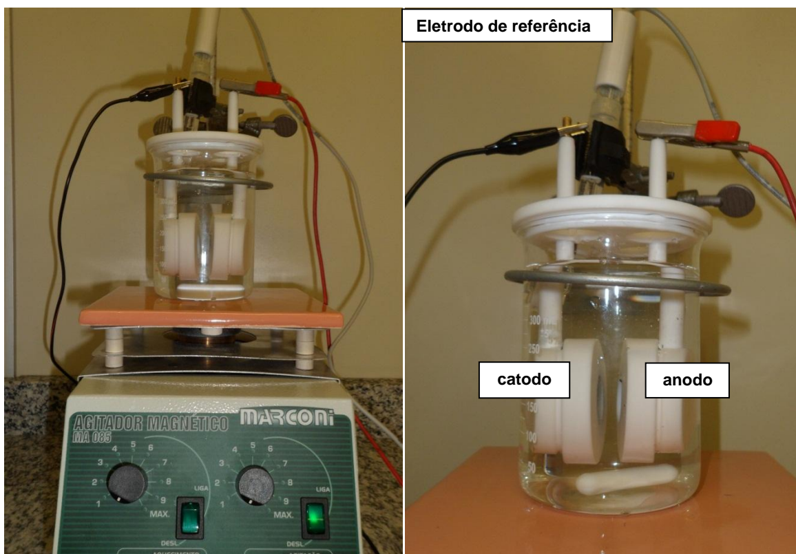
Figura 3.3 - Imagem referente ao esquema adotado para eletrólise
