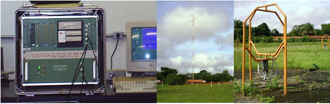
Figura 3.3 - Digisonda DPS-4, antena de transmissão e antenas de recepção localizadas em São Luís (MA), respectivamente.
