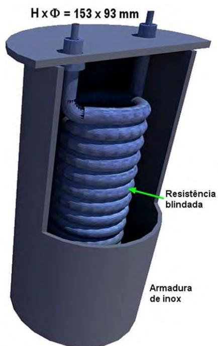
Figura 2.6 - Resistência de Teste.
