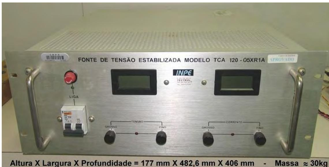
Figura 2.4 - Fonte DC para energização, via cordão umbilical, do forno na fase de pré-lançamento.
