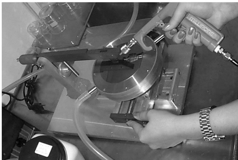
Figura 9.2. Aparelho riscador, desenvolvido no INPE-LAS para clivar/cortar as lâminas de silício.
