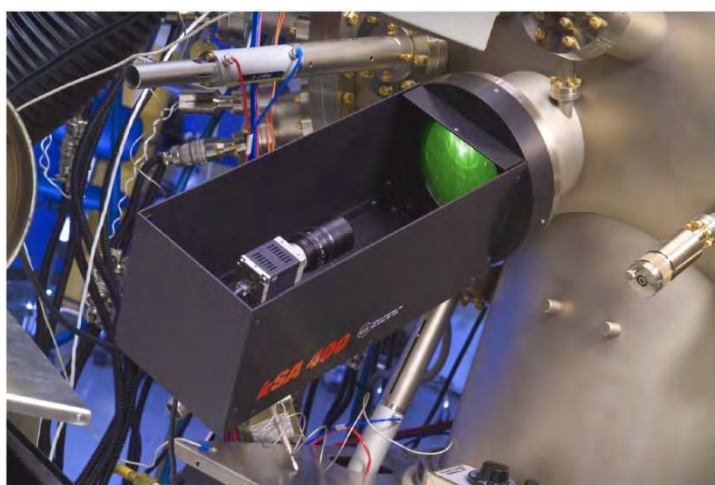
Figura 3.6. Equipamento de RHEED da Staib Instruments, 35 KeV, usado neste trabalho.
