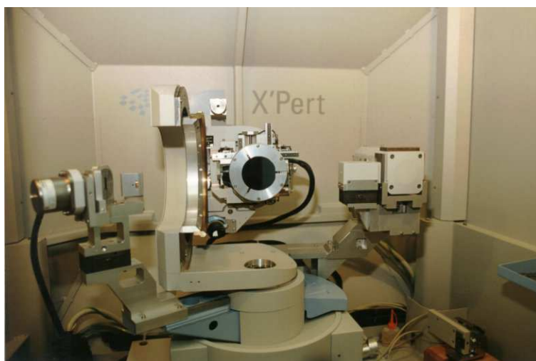
Figura 5.6. Vista frontal da câmara interna do difratômetro de raios X de alta resolução Philips X'Pert MRD na configuração de Triplo Eixo.
