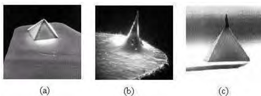
Figura 4.3. Modelos mais comuns de pontas usadas em AFM. a) Ponta no formato piramidal. b) Ponta cônica. c) Ponta piramidal com estrutura mais fina em sua extremidade.
