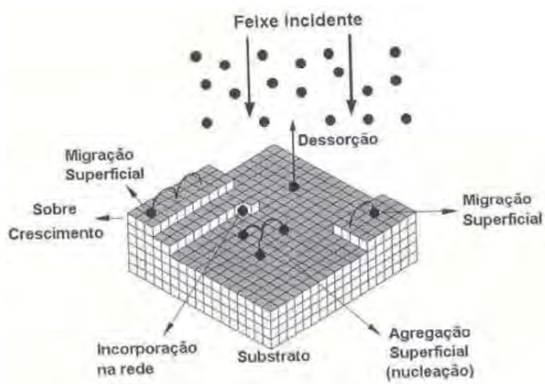
Figura 2.3. Ilustração dos processos que ocorrem junto à superfície do substrato durante o crescimento MBE.
