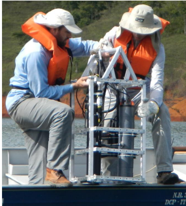
Figura 5.8: AC-S sendo colocado na água.
