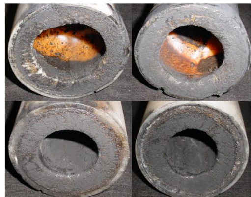
Figura 14- Grãos propelentes após queima
