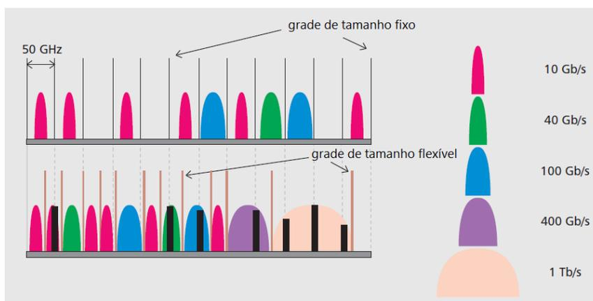
Figura 1 – Grades de tamanho fixo e flexível (Adaptada de Gerstel *et al.*, 2012)
