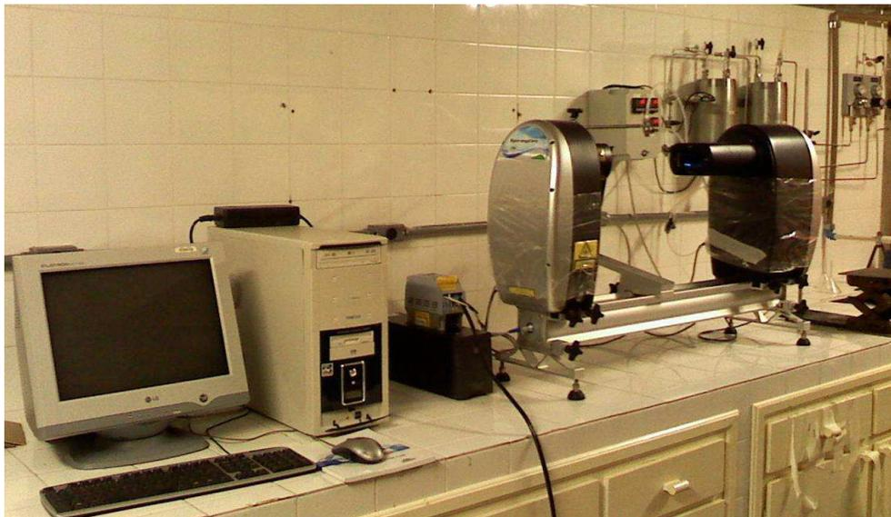
Figura 3.4 - Foto da bancada de testes de atomização.
