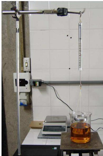
Figura A.3 - Arranjo experimental para realizar a medição da tensão superficial de um líquido.
