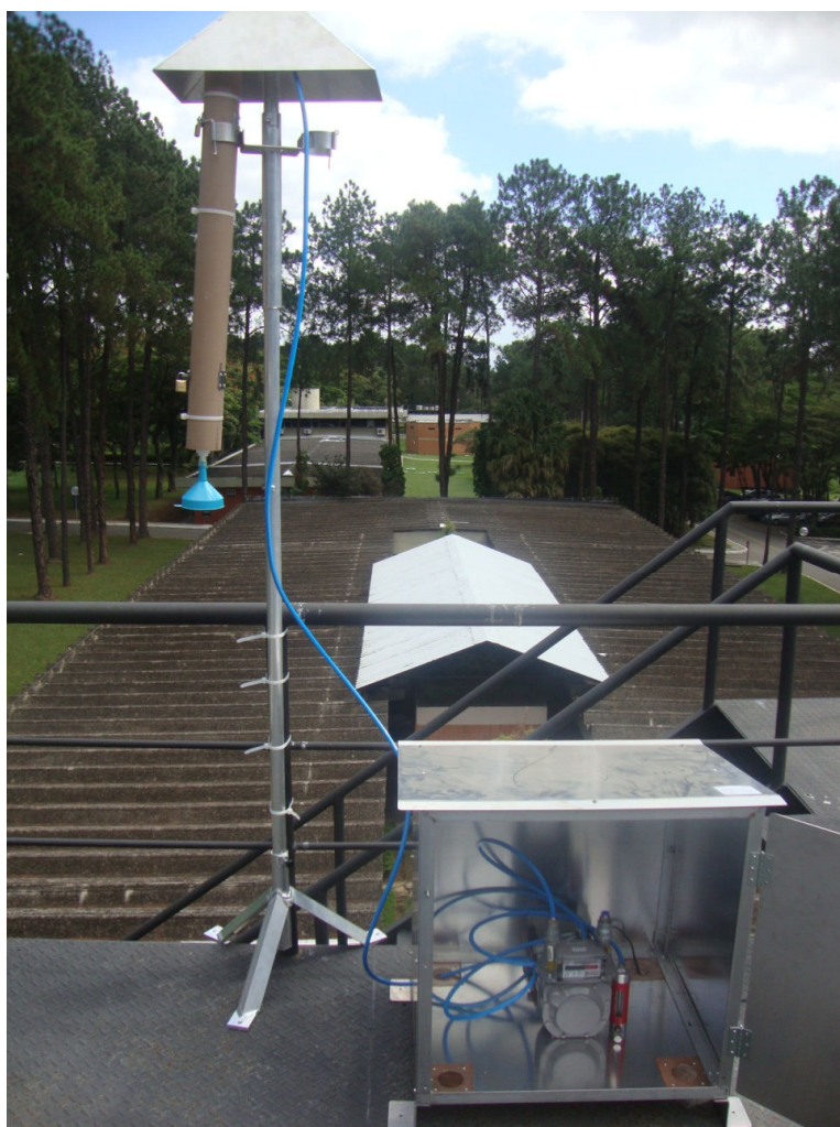
Figura 8 – Sistema SAAD montado em suporte construído especificamente para essa finalidade e abrigo para o sistema de bombeamento, bateria e controlador da placa solar (instalada sobre o abrigo).
