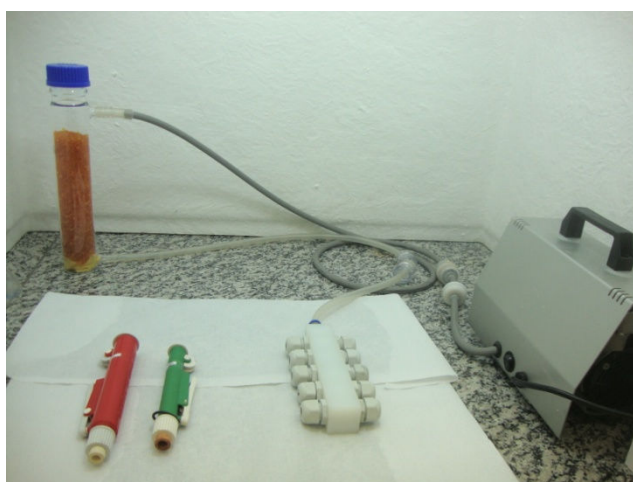
Figura 4 – Detalhes do sistema de secagem cujo circuito é composto por bomba, dois filtros impregnados com solução básica e ácida, respectivamente sílica gel laranja para retenção de umidade e “manifold” onde são acoplados 10 denuders para secagem simultânea.
