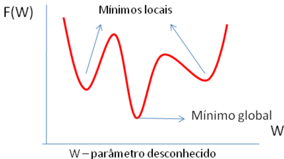
Figura 2.11 - Esquema que mostra uma dada função com seus mínimos locais e um único mínimo global, o qual é o valor ótimo da função.
