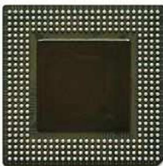
Figura A.1 - Vista da face inferior do componente da Intel (*Embedded Pentium MMX*), mostrando as esferas de solda.
