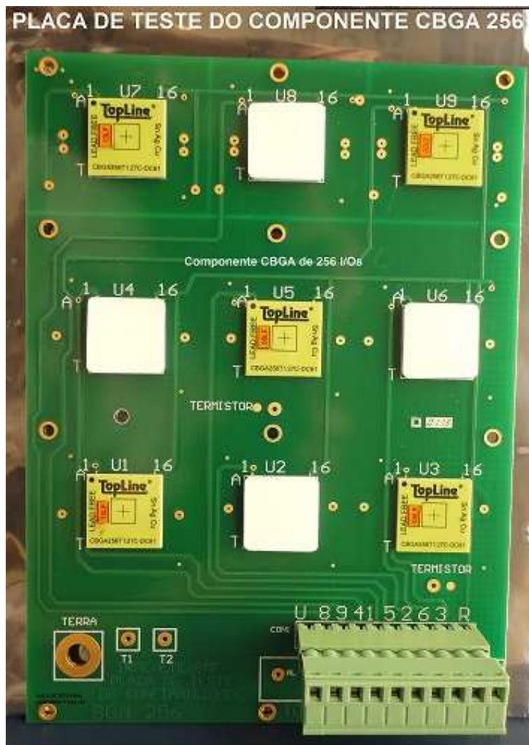
Figura 5.17 - Placa de Teste para o componente CBGA 256.
