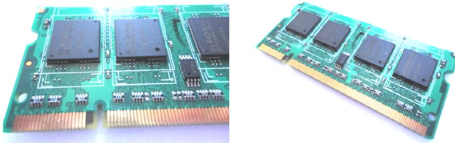
Figura A.2 - BGAs montados em PCI de memórias de computadores pessoais.
