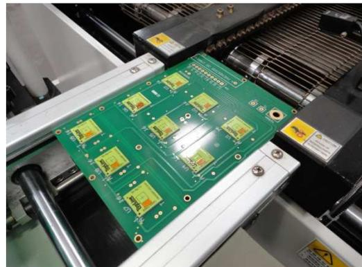
Figura 5.13 - Fotos das Placas de Teste no momento da entrada nas zonas de aquecimento de soldagem.
