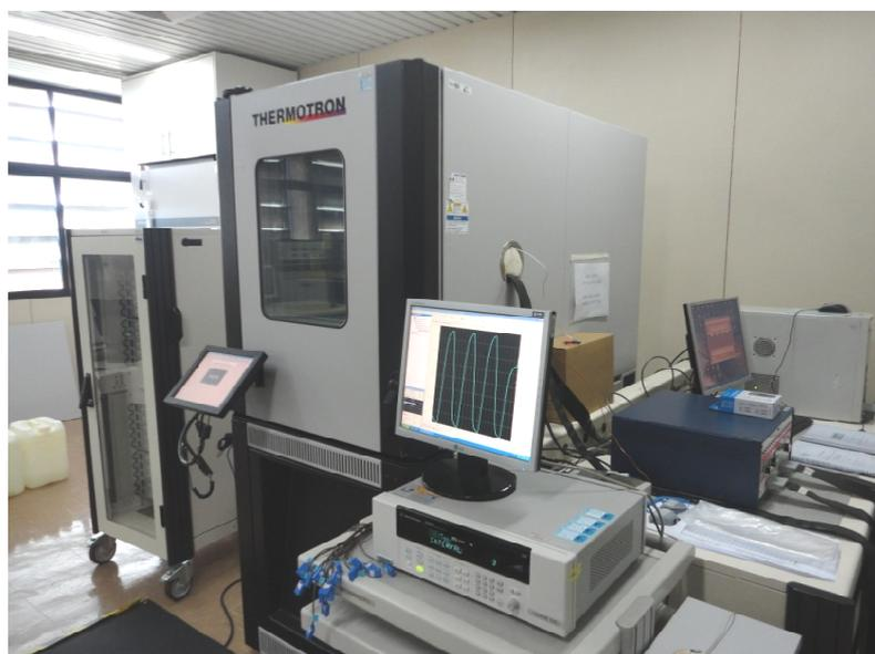
Figura 5.15 - Foto da câmara térmica com demais equipamentos e instrumentos associados para a realização do teste acelerado no Laboratório de Integração e Teste do INPE (LIT-INPE).
