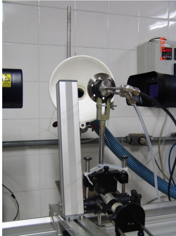
Figura 9.7 - Imagem da posição espacial do injetor frente ao instrumento de difração laser.
