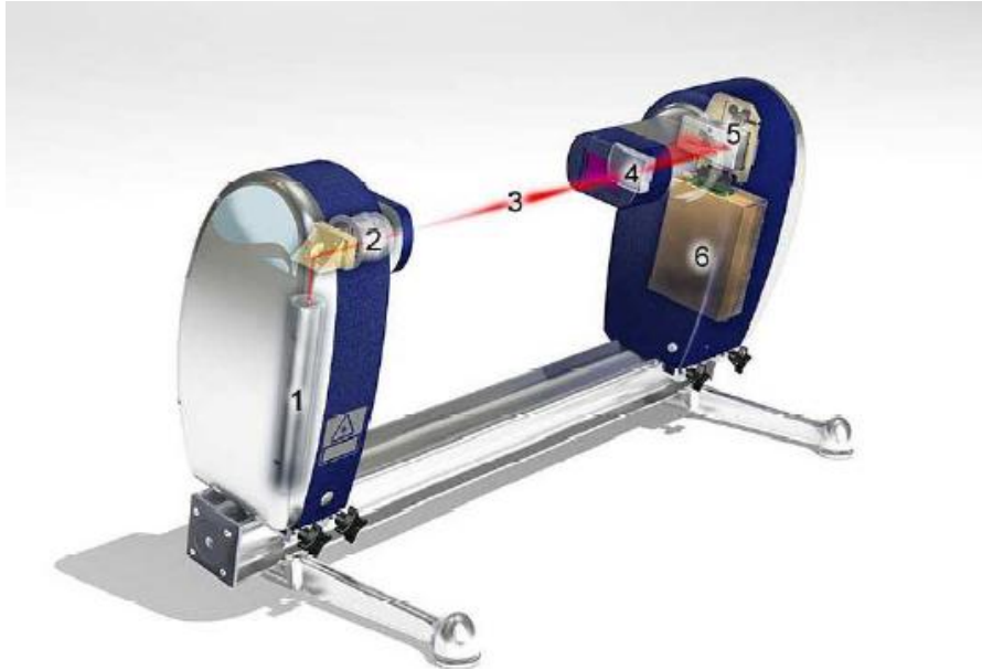
Figura 9.5 - Sistema de difração laser Spraytec da empresa Malvern: (1) fonte de luz a laser, (2) óptica de colimação, (3) região de medição, (4) lentes coletoras de dados, (5) detector de espalhamento de luz, (6) eletrônica para aquisição de dados.
