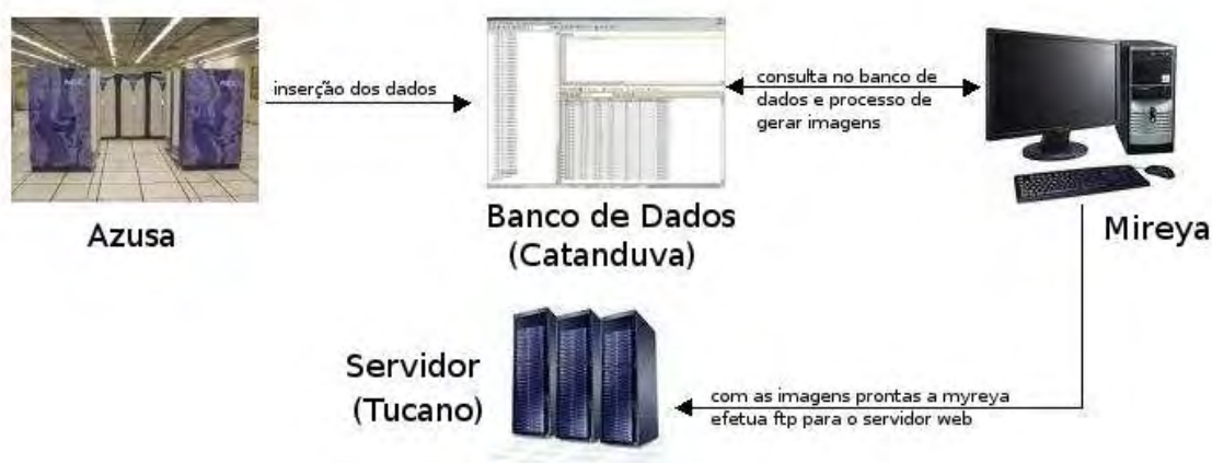
Figura 1 - Esquema ilustrativo da estrutura em que as diferentes máquinas se relacionam e as funções que cada uma exerce nesse processo.
