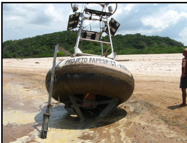
Figura 2.10 – SIMA Curuai após o rompimento da âncora em setembro de 2008.
