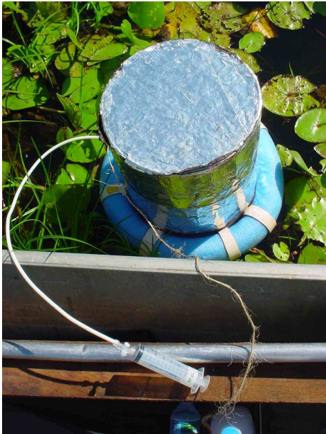
Figura 4.2 – Conjunto para a coleta de ar com a cúpula e seringa.
