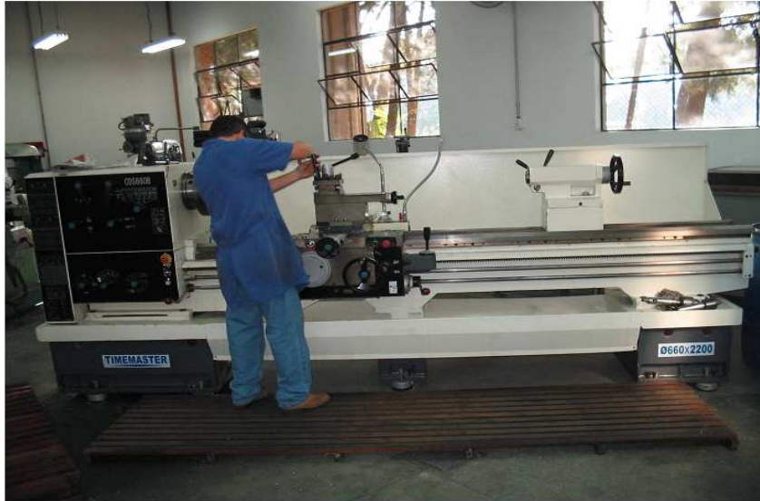
FIGURA 3.3 - Torno semi-automático utilizado nos ensaios e alocado no SEMA/INPE.
