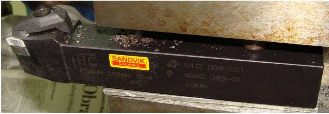
FIGURA 3.5 - Porta ferramentas da marca Sandvik CSBNR2525M12-4.
